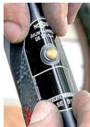
Tornillo instalado en el cuadro.
