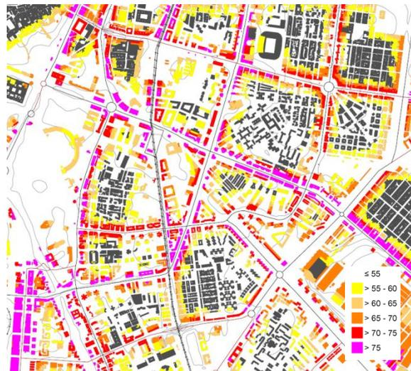
Figura 8.67: Fachada más afectadas por el conjunto global de emisores para el indicador Lden
