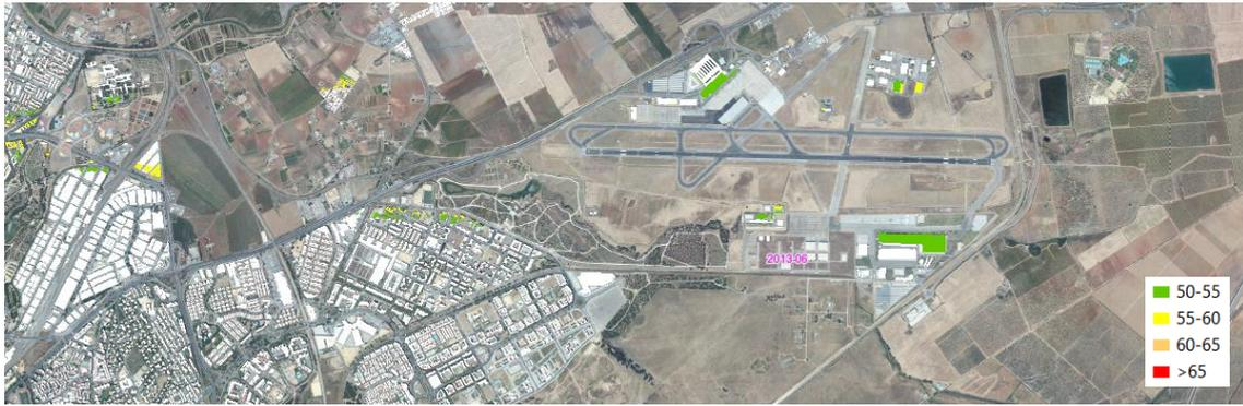
Figura 8.54: Fachadas más expuestas a la afección del tráfico aéreo para el periodo de tarde
