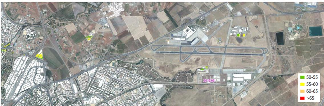
Figura 8.53: Fachadas más expuestas a la afección del tráfico aéreo para el periodo de día
