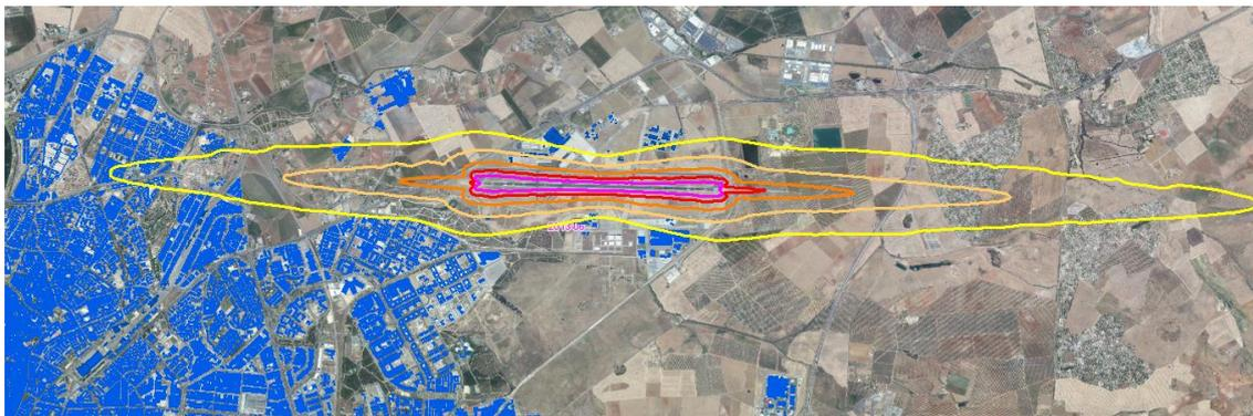
Figura 8.49: Huella acústica del aeropuerto de Sevilla para el indicador Lden.
