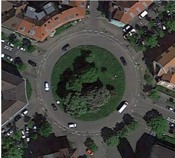
*Ejemplo de glorieta con carril bici unidireccional en calzada. Se trata de un ámbito residencial de bajo tráfico y obsérvese como las entradas y salidas disponen de radios de giros estrictos para los vehículos*
