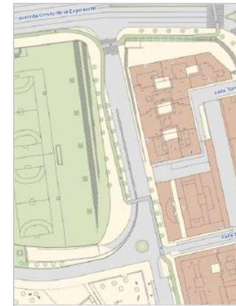
Vía en calle Radio Sevilla. Ejemplifica el caso de varios tramos de la red en que se abusa del cambio de margen del carril bici en tramos cortos. En este caso la justificación parece ser el respeto a una banda de aparcamiento de unos 50 m (unas 10 plazas). Ratio de sinuosidad local =1,2
