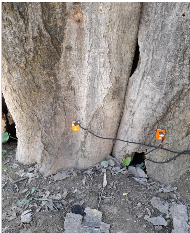
11. Base de tronco con cavidad visible. Sensores conectados para monitoreo de todo el perímetro del tronco
