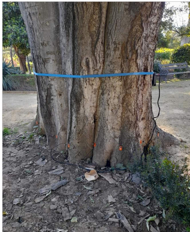
12. Instalación de sensores en la base del tronco para registro de variables en madera con presencia de cavidades.
