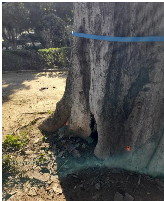
13. El tomógrafo sónico es un método no invasivo de medición de las ondas de sonido que recorren la madera de la sección objeto de estudio
