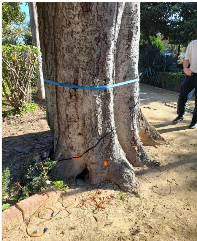
13. El tomógrafo sónico es un método no invasivo de medición de las ondas de sonido que recorren la madera de la sección objeto de estudio
