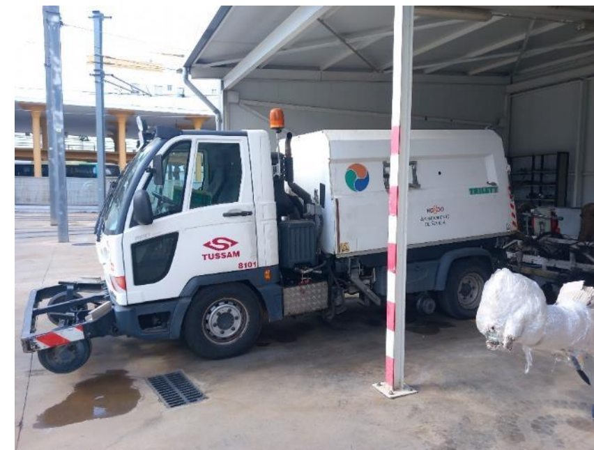
Fotografía 23.- Máquina bivial de limpieza de vías en marquesina
